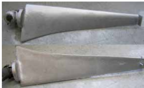
图9：侧边浇注叶片的两面
